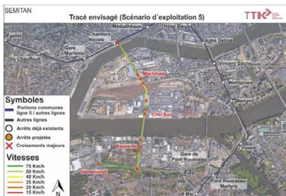
Scénario d'exploitation proposé et simulé avec OpenTrack avec graphique d'exploitation à trois lignes sur le tronçon commun (Source : TTK)
