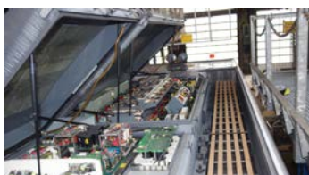
Elektrische Ausrüstung auf dem Dach (u.a. 4 Quadranten-Steller, Bordnetzumrichter)
