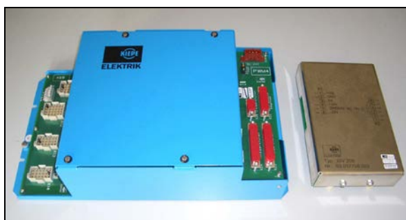
Supervisory Control Unit – Steuerungs- und Kontrolleinheit
