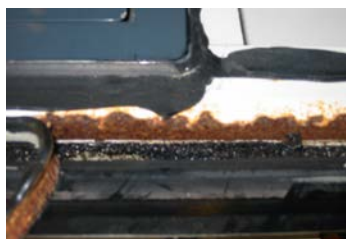
Korrosion am Wagenkasten
