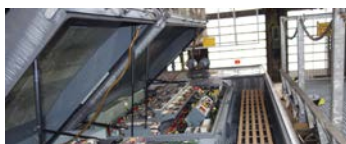
Equipement électrique sur le toit (entre autres : 4 Quadraten-Steller, Convertisseur embarqué)
